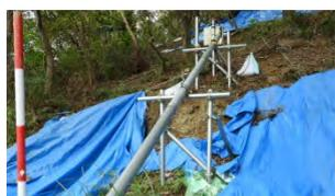
写真-1 頂部の変状と伸縮計設置状況
