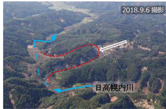
写真3 北海道胆振東部地震による河道閉塞
