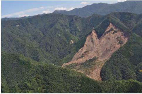
写真-1 崩壊 2 日後の栗平地区の様子. 幅 600m, 高さ 450m, 長さ 650m.
