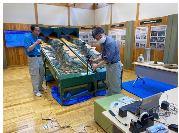
写真-1 砂防堰堤の種類と機能に関する実験（オンライン配信）の様子
