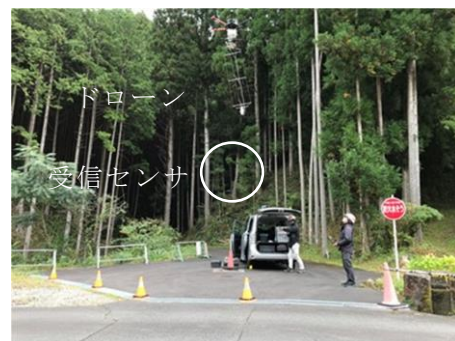
写真-3 栃尾地区でのドローン空中電磁探査の様子(ドローンが飛び立つところ、2021年10月)
