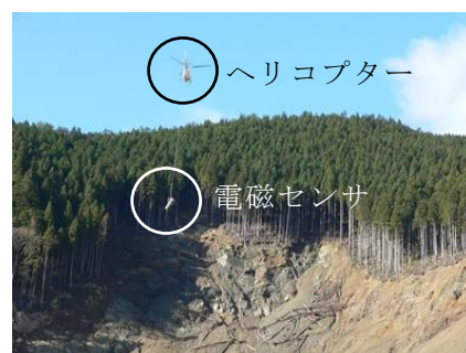
写真-2 奈良県天川村の深層崩壊発生斜面(冷水(ひやみず)地区)でのヘリコプター空中電磁探査の様子(2012年12月)
