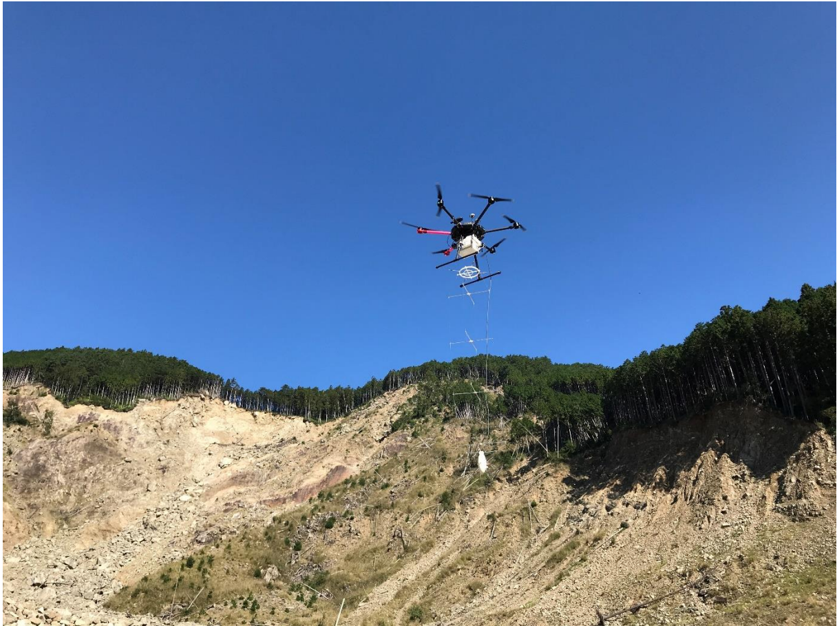
図-5 和歌山県田辺市熊野地区におけるUAVを用いた空中電磁探査の様子
