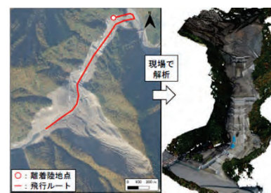
図-2 UAV レーザ計測の概要
