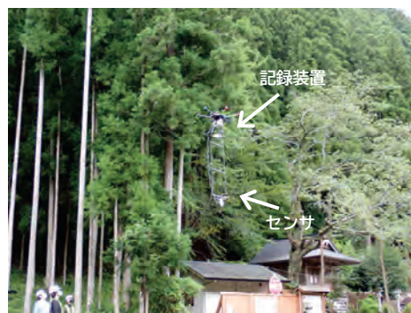
ドローンによる空中電磁探査の実施状況
