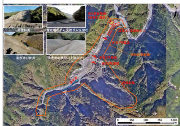
図 2 赤谷地区における UAV 搭載レーザによる河道閉塞地形計測範囲
