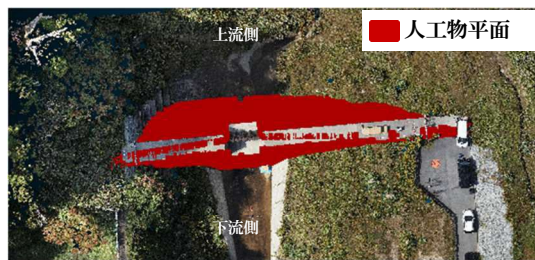
図 7 RANSAC 法による砂防設備の抽出結果
