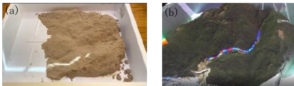
図7 砂で作った地形模型へのプロジェクションマッピングの様子 (a) 土砂災害啓発センター付近の土石流溪流の地形模型 (b) iRIC で計算した土石流流下動画と衛星画像の投影
