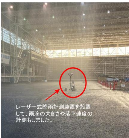
レーザー式降雨計測装置を設置して、雨滴の大きさや落下速度の計測もしました。
