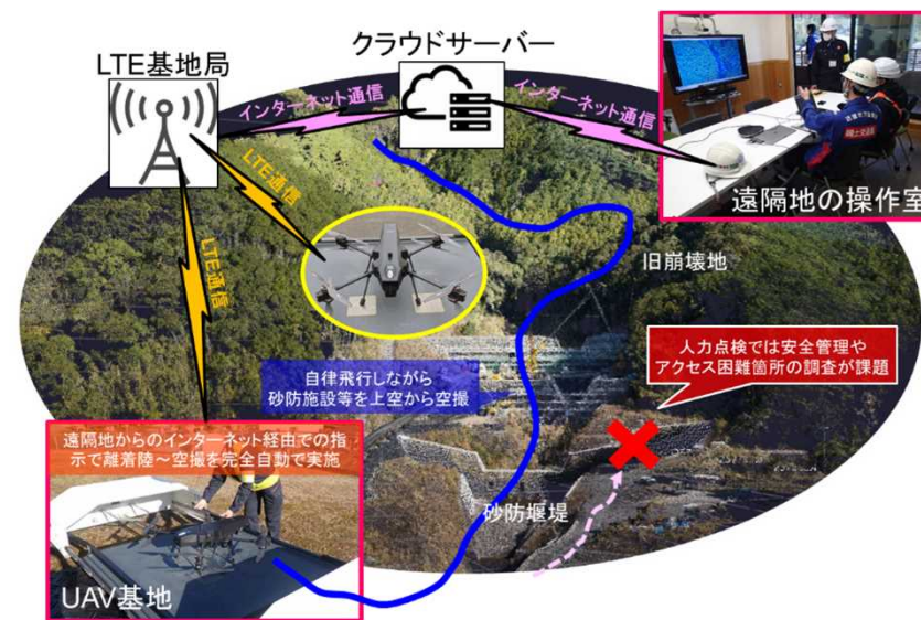
ドローン基地を用いた砂防施設の完全自動点検
