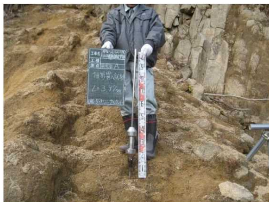
簡易貫入試験による土層厚調査
