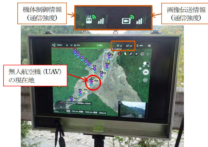
図 2.3.3-2 機体とプロポとの通信状態の確認事例（操縦アプリケーション）
