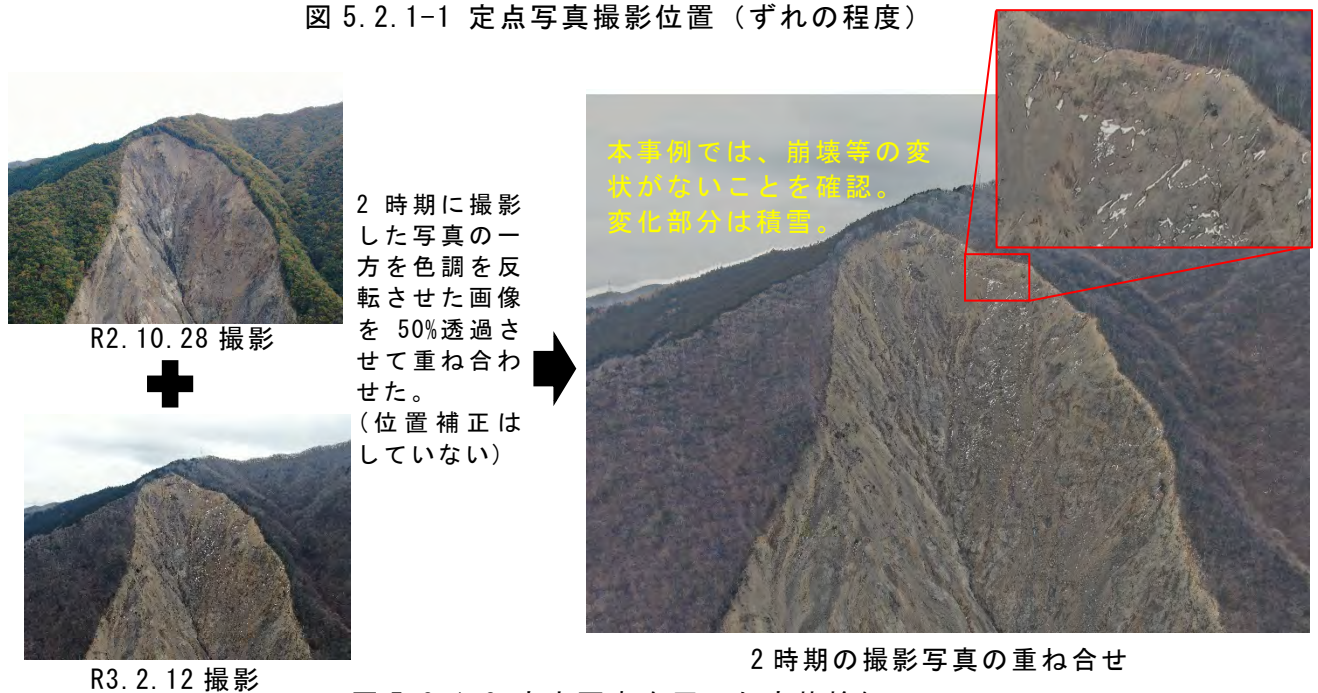
図 5.2.1-2 定点写真を用いた変状検知
