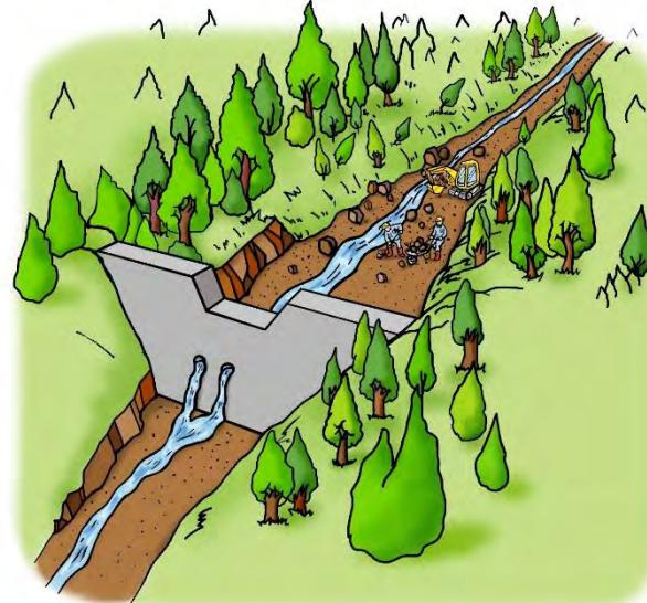
② 不透過型砂防堰堤を設けると、堰堤の上流側に
