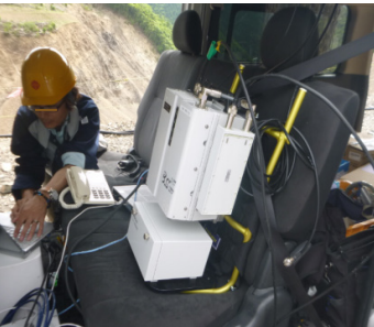
公共BBをつかって衛星通信可能エリアまで映像を伝送
