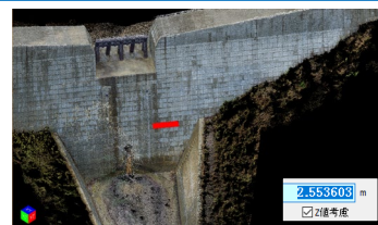
3次元モデルを使った点検例
