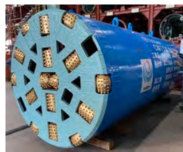
排水トンネル工事に使用する掘削機
