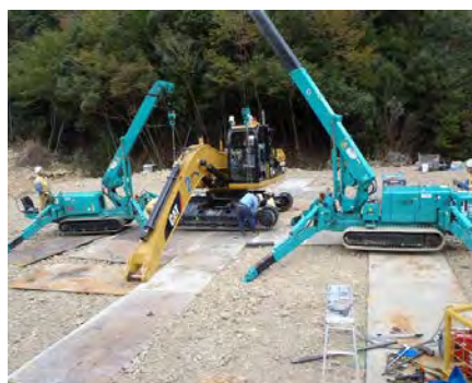
カニクレーン（分解型）を使用して油圧ショベル（分解型）を組立（長殿地区）
