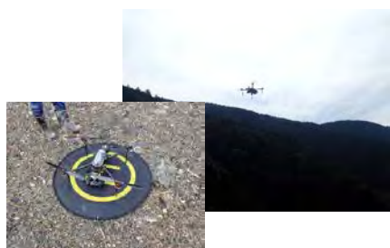
UAVによる 施工前の空中写真測量
