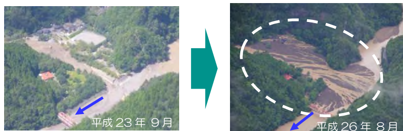
荒廃地からの土砂流出に伴う河床上昇による治水安全度の低下 (赤谷川 川原樋川合流地点 (五條市))
