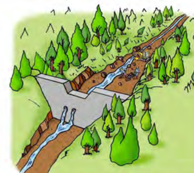
② 不透過型砂防堰堤を設けると、堰堤の上流側に土砂が少しずつたまっていきます。土砂をためる量を確保するため、取り除くこともあります。
