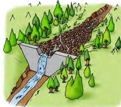
③ 大雨が降り土石流が発生したとき、堰堤は大きな岩や流木などを含む土砂をため、下流への被害を防ぎます。
