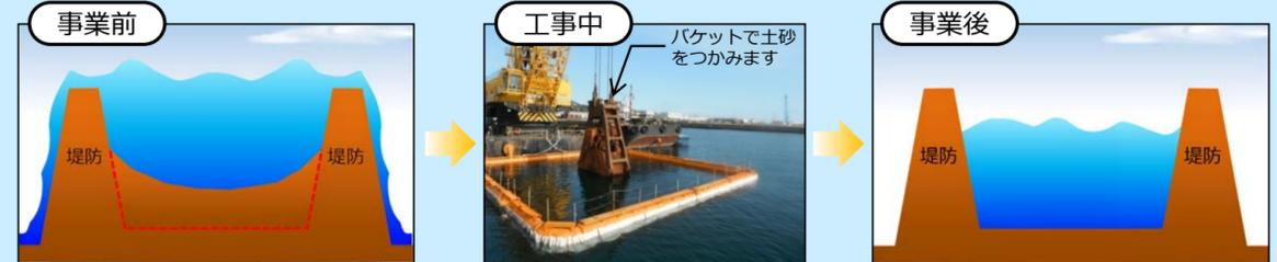
川底などを掘り下げたり、広げたりして水の流れる断面を大きくすることで、洪水を低下させます。
