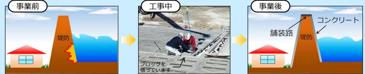
堤防が洪水で崩れないようにコンクリートブロックで表面を強化します。
