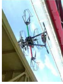
道路橋の損傷写真を撮影するカメラを搭載したドローン
