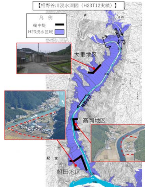
図-8 相野谷川沿いの輪中堤整備
