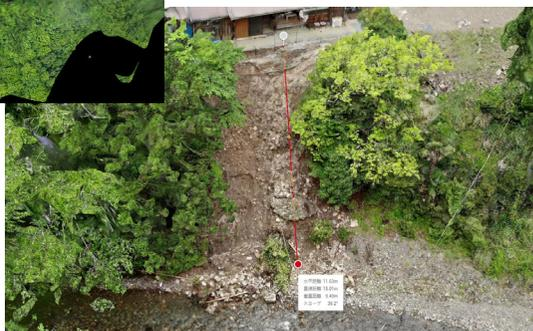
災害現場のデジタルツイン(距離、高さ、面積を瞬時に計測可能)
