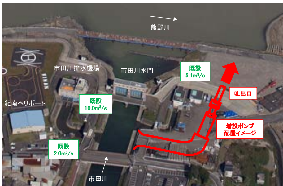
図－2.2 市田川排水機場ポンプ増強
