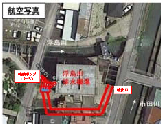
図－2.3 浮島川排水機場補助ポンプ整備
