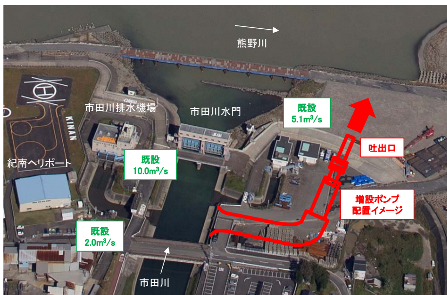
図－2.2 市田川排水機場ポンプ増強
