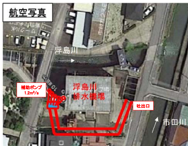
図－2.3 浮島川排水機場補助ポンプ整備
