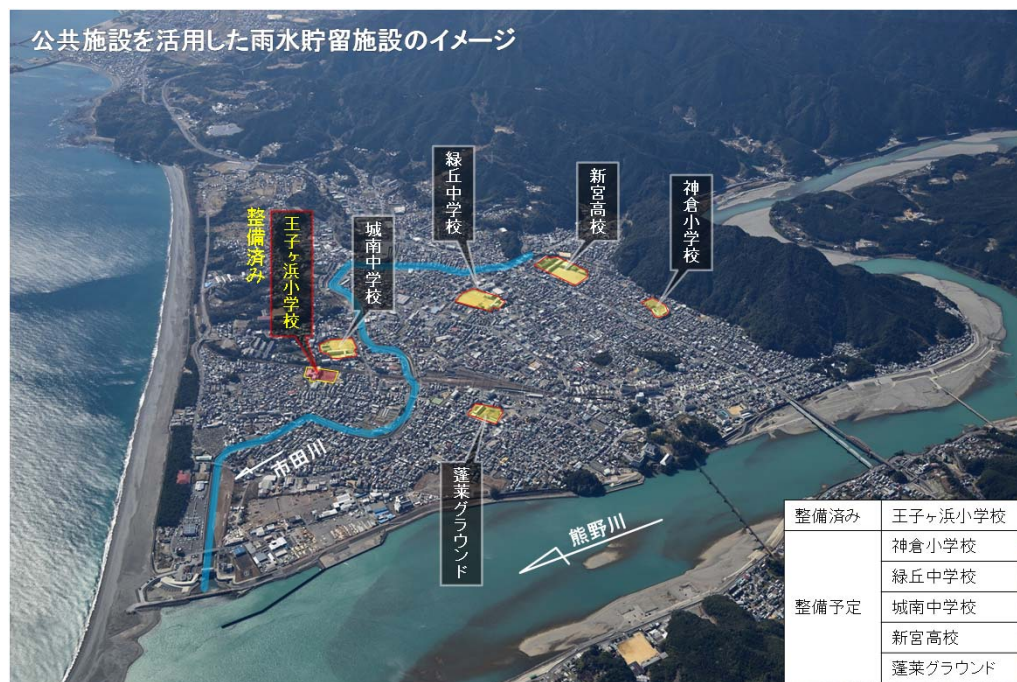
公共施設を活用した雨水貯留施設のイメージ
