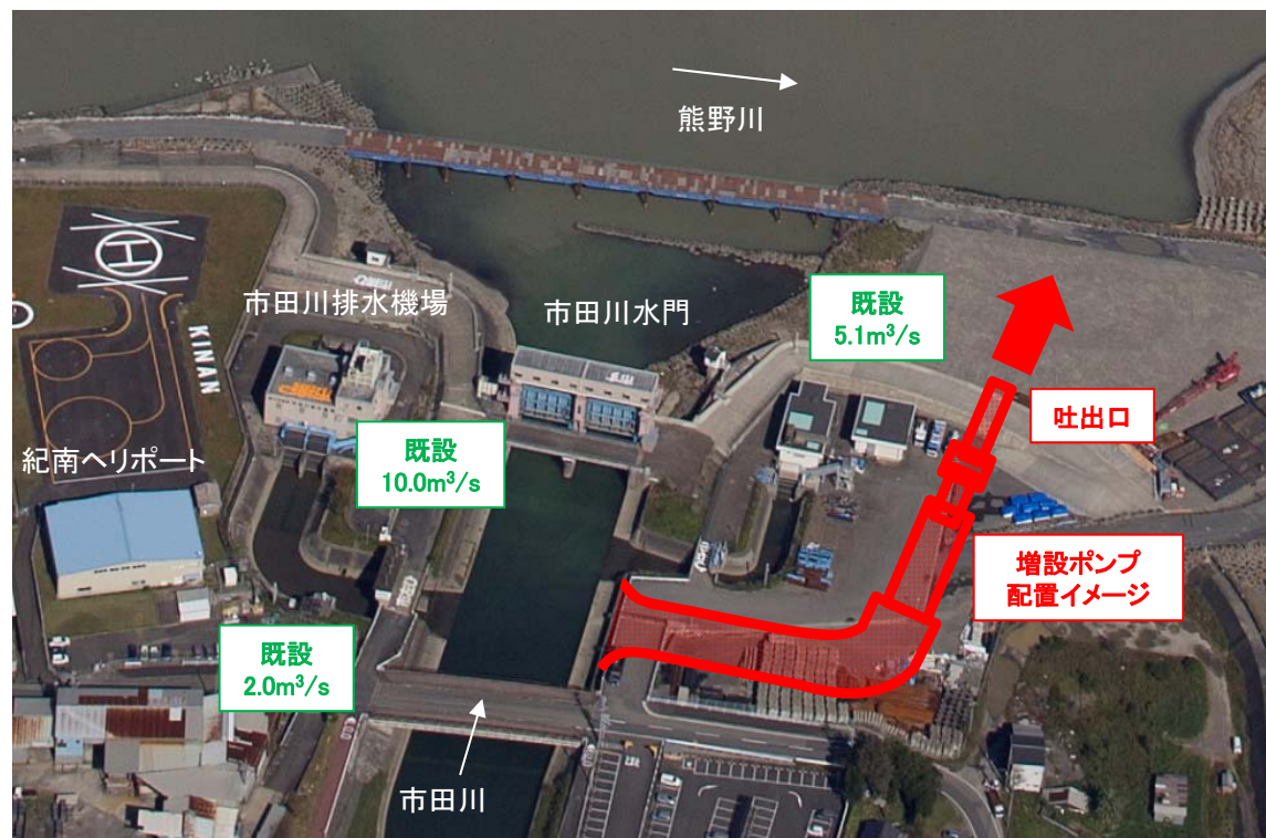
市田川排水機場ポンプ増強
