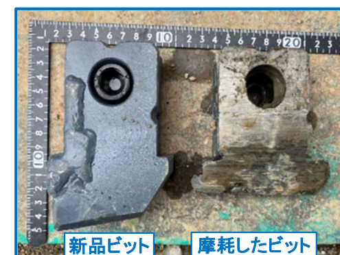
硬質岩によりビットが損耗し掘削難航
