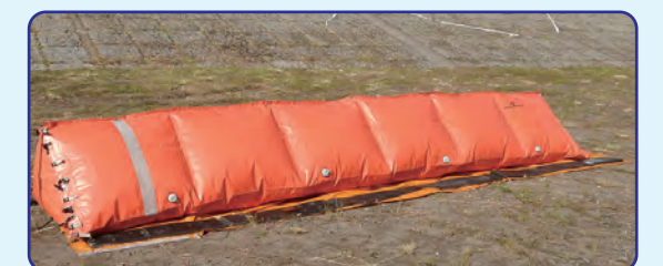
訓練のため水の代わりに空気を入れて膨らませる (実際は水を充填)
