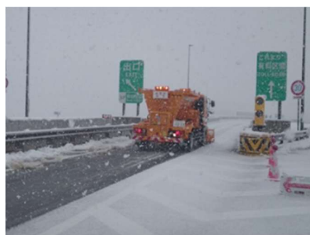
凍結防止剤散布作業
