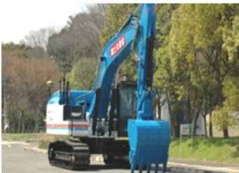
分解対応型バックホウ (無人化施工)
