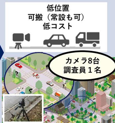
**【技術の背景】** 調査員による交通量調査は、長時間作業や膨大な人件費などが課題である。今後の全国道路・街路交通情勢調査は、人手調査を廃止しカメラ映像のAI解析を導入していく方針である。しかし、既存カメラの多くは高所撮影であり、計測箇所が限られ、自動車類4分類の検出も難しい。そこで、設置制約が少なく、簡単かつ高精度に自動計測可能なシステムを開発した。
