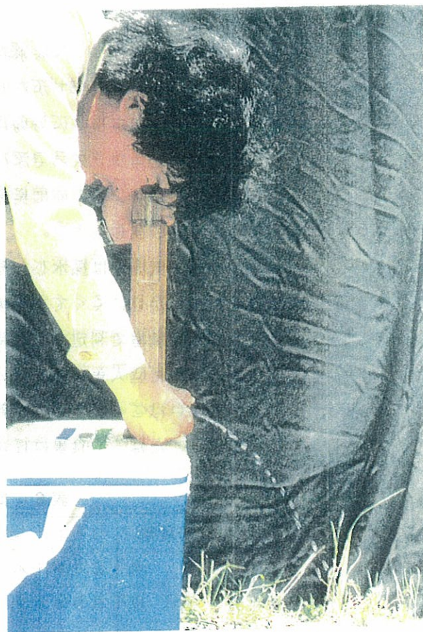
写真14 透視度の測定
