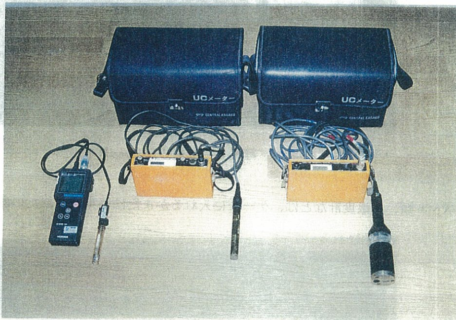
写真7 携帯用計測器の例（左からpH計、導電率計、DO計）
