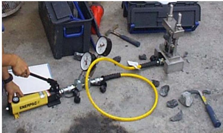
図-参1-4 ポイントロード試験状況
