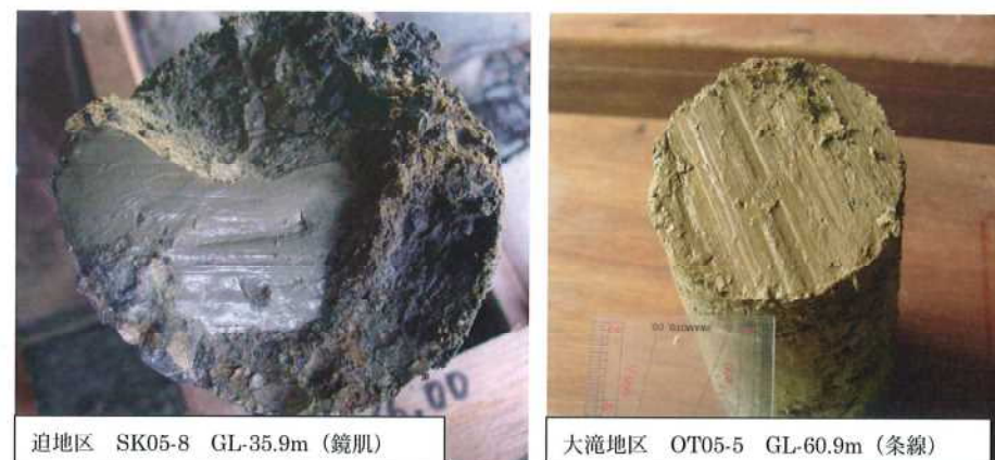
写真 4.1 推定すべり面で認められた鏡肌と条線
