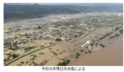
令和元年東日本台風による長野市穂保地先の堤防決壊、浸水被害状況
