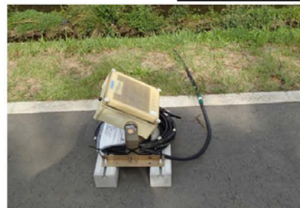
堤防に設置するタイプ （ケーブル（計測器）を河川に入れて計測）
