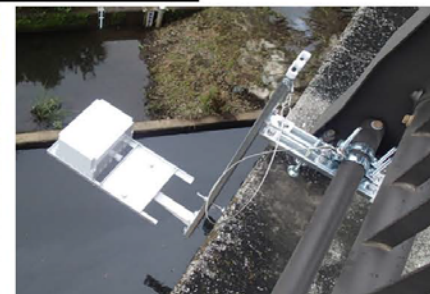
橋梁に設置するタイプ （電波や超音波で河川に触れずに計測）
