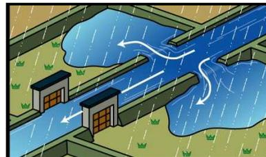
排水門を閉め、川の水位が越流堤を超えると遊水地内に洪水が流入します。
