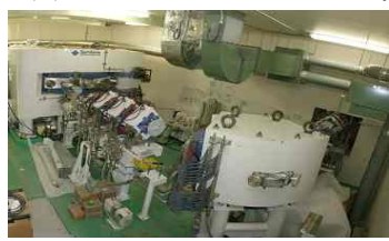
BNCTに適した強度の中性子を発生させることのできる小型加速器
