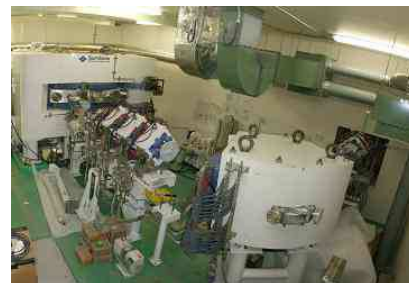
BNCT に適した強度の中性子を発生させることのできる小型加速器 (大阪府熊取町内の京都大学原子炉実験所の加速器)
