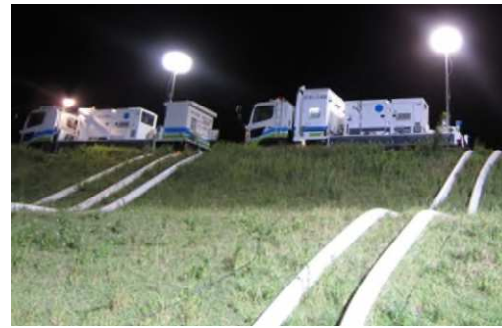
京都府等の台風18号等による大雨被害時の 配水ポンプ車による緊急排水(福知山市荒河地先) (大規模災害時における連携実績) 提供: 近畿地方整備局
