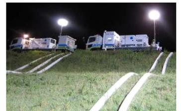
京都府等の台風第18号等による大雨被害時の排水ポンプ車による緊急排水（福知山市荒河地先）
