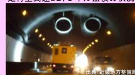
走行型高速3Dトンネル点検の状況
