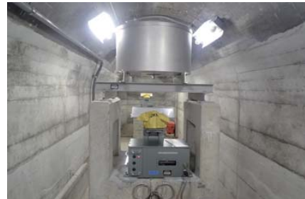
変形量の計測(ブラムライン)
