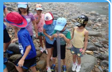
透視度計で透明度を測定
