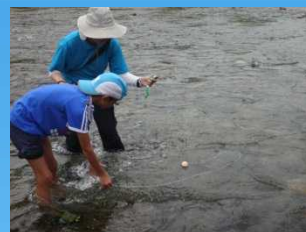
ピンポン球で流速を測定
