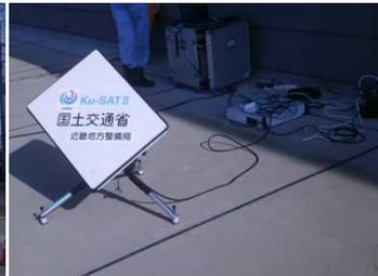
KU-SAT II (衛星通信機器)
