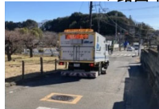
(空洞探査車による調査)
