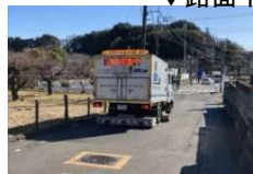
(空洞探査車による調査)
