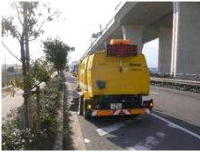
路面清掃作業
