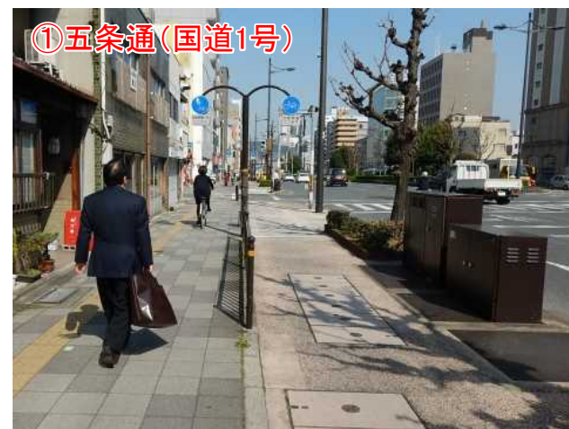
自転車道(標識設置。幅広歩道を柵で分離。)
