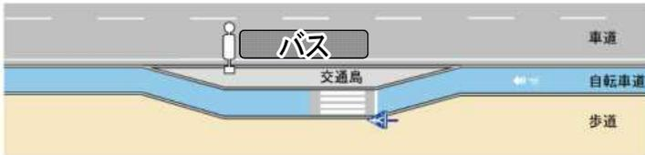
図 II-14 車道と自転車道との間に交通島のバス停留所を設ける例 (島型)
