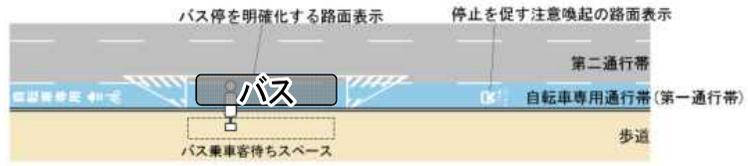
図 II-17 ストレート型バス停を設置する例
