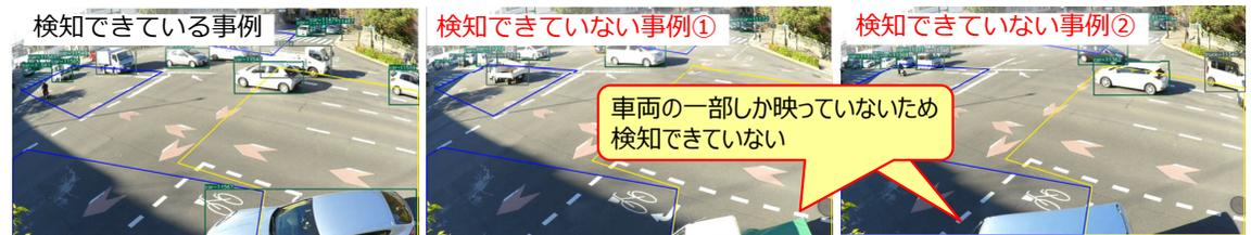
バス等の大型車の影に隠れて検知できない (例: 東山丸太町交差点の右折車両)
