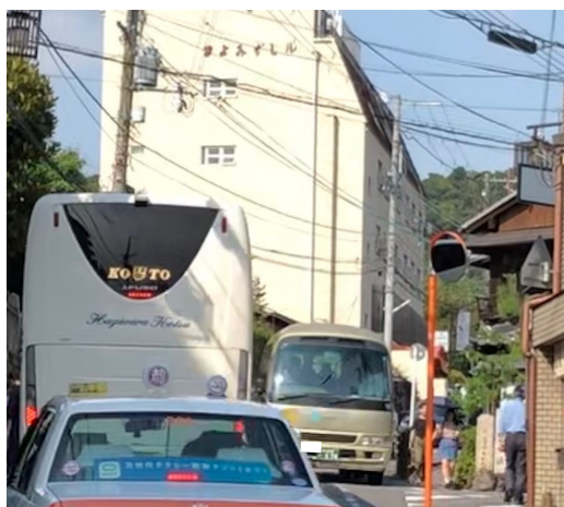
電柱箇所では 大型バスの離合が困難
