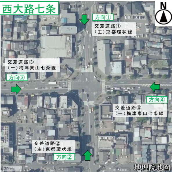
← : 基準速度を満たす方向 → : 基準速度を満たさない方向 (主): 主要地方道、(一): 一般府道
