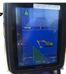
バックホウに搭載された コントロールボックス
