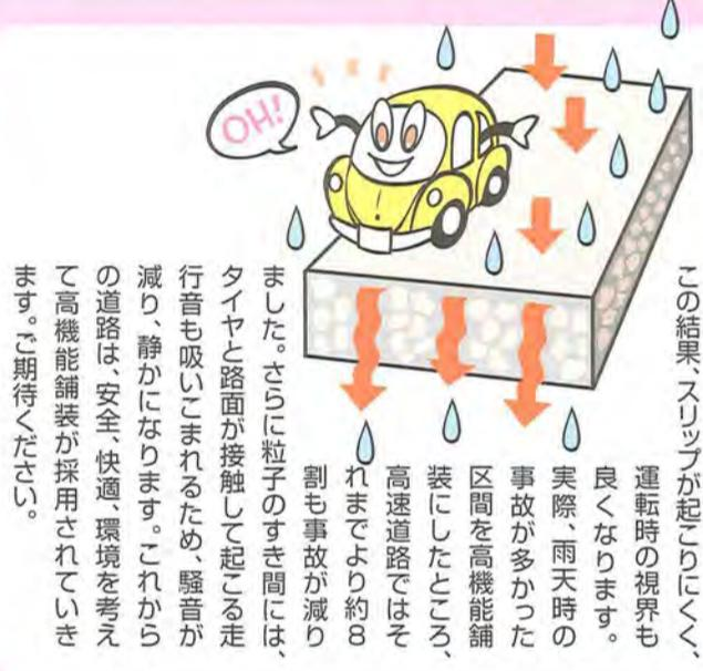
安全で快適な未来の道路をつくる。「高機能舗装」が注目されています。「高機能舗装」は、従来の舗装と比べて粒子のすき間の多い構造が特徴。雨が降ってもすき間から路面の下へと雨水が排水されるため、路面に水がたまらず、水はねも減ります。この結果、スリップが起こりにくく、運転時の視界も良くなります。実際、雨天時の事故が多かった区間を高機能舗装にしたところ、高速道路ではそれまでより約8割も事故が減りました。さらに粒子のすき間には、タイヤと路面が接触して起こる走行音も吸いこまれるため、騒音が減り、静かになります。これからの道路は、安全、快適、環境を考えて高機能舗装が採用されていきます。ご期待ください。
