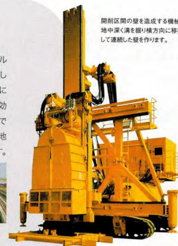
開削区間の壁を造成する機械。地中深く溝を掘り横方向に移動して連続した壁を作ります。
