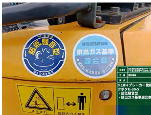
図 5-14 低騒音型建設機械の採用
